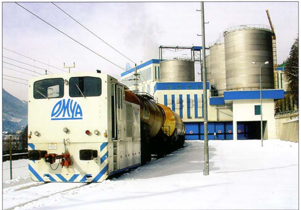
Abb. 3: 44 Tonnen schwere Rangiermaschine aus dem Jahr 1985
