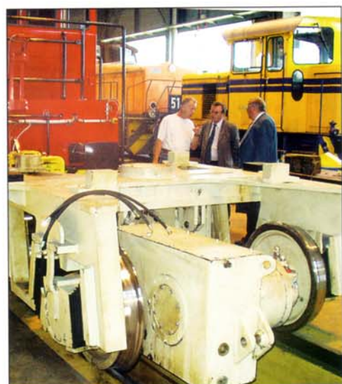
Abb. 4: Drehgestell einer vierachsigen Lok für eine deutsche Raffinerie
